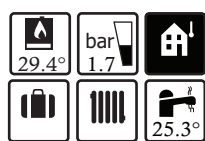
Obr.6 V případě, že je připojeno venkovní čidlo
