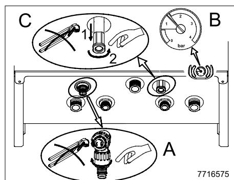
Pravidelně ověřujte, jestli má tlak načtený na tlakoměru B, při studeném zařízení, hodnotu 1 – 1,5 bar. V případě nízkého tlaku působte na napouštěcí ventil systému C kotle.
