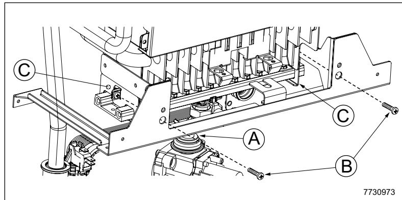
**UPOZORNĚNÍ:** jednotlivé trysky se nesmí z rampy odšroubovat, je třeba vyměnit celou rampu.
