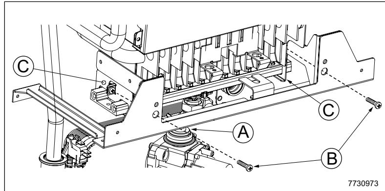
**UPOZORNENIE:** jednotlivé dýzy sa nesmú z rampy odskrutkovať, je treba vymeniť celú rampu.
