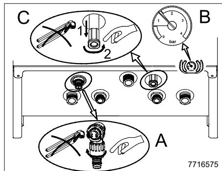
Pravidelne kontrolujte, či tlak načítaný na tlakomeri B pri studenom systéme uvádza hodnotu v rozmedzí 1 - 1,5 bar. V prípade nízkeho tlaku pôsobte na ventil pre naplnenie systému **C** kotla.
